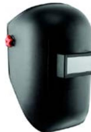
**Careta Para Soldador** Fabricada en material termoplástico. Ventana de 50 mm x 108 mm. Cuerpo sumamente amplio para proveer al usuario una mejor ventilación. Ligera y confortable. Recomendada para trabajo ligero. Resistente a los impactos y rebabas de soldadura. Cuenta con matraca y almohadilla frontal. No incluye cristal.
